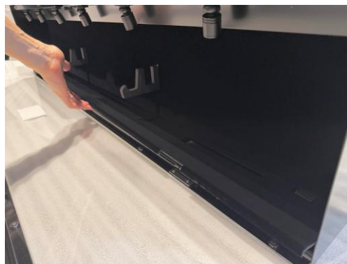
土台を外す（磁石で固定されています） ※ペロアを押しつぶさないよう注意
