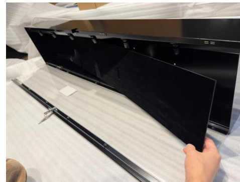
ヒンジとパネルが固定されているネジを4か所外しアクリルパネルを外す
