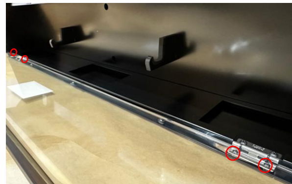
ヒンジとパネルが固定されているネジを4か所外しアクリルパネルを外す
