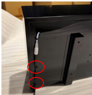
付属のACコードを繋ぎ 必ずクランプをします。
